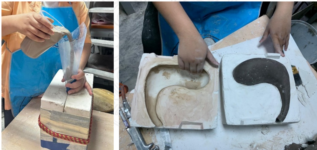
ภาพที่ 8 (ภาพซ้าย) เทน้ำดินลงแม่พิมพ์ปูน
