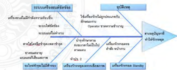
รูปที่ 1 แผนผังก้างปลาแสดงสาเหตุการทำให้เครื่องจักรหยุดทำงาน
