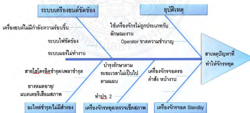
ภาพที่ 4.14 แผนภูมิแกงปลาแสดงสาเหตุย่อยการทำให้เครื่องจักรหยุดทำงาน
