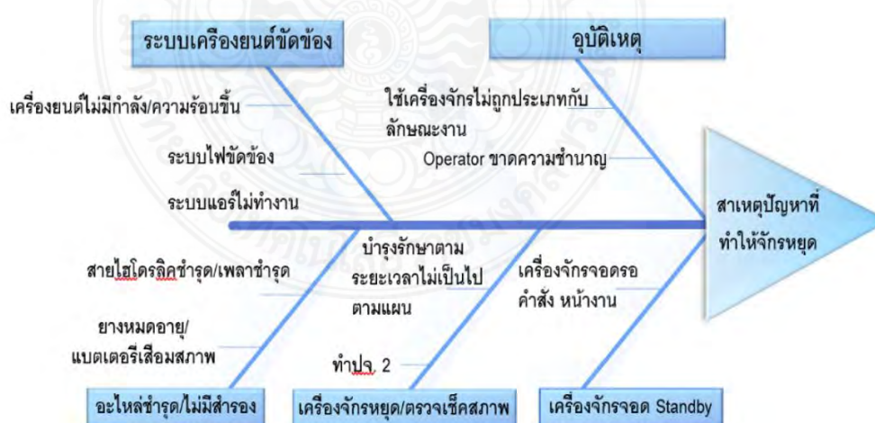
ภาพที่ 4.4 แผนภูมิแก๊งปลาแสดงสาเหตุของการทำให้เครื่องจักรหยุดทำงาน
