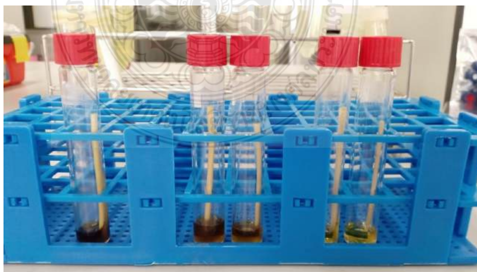
ภาพที่ 4.5 การทดสอบความสามารถในการแพร่ผ่านไม้กระเจายกลิ่น
