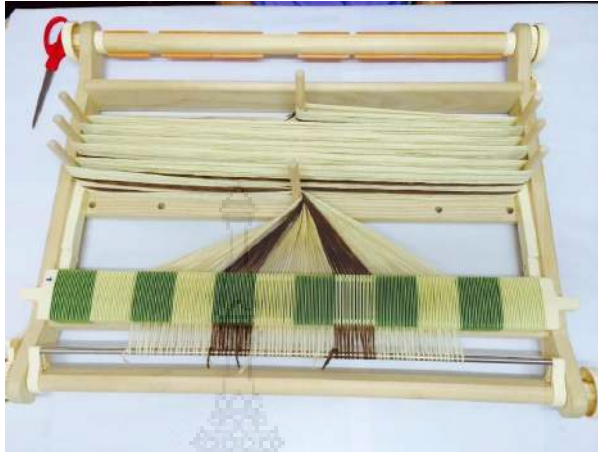
ภาพที่ 3.11 การโยงเส้นด้ายขั้นตอนที่ 5
