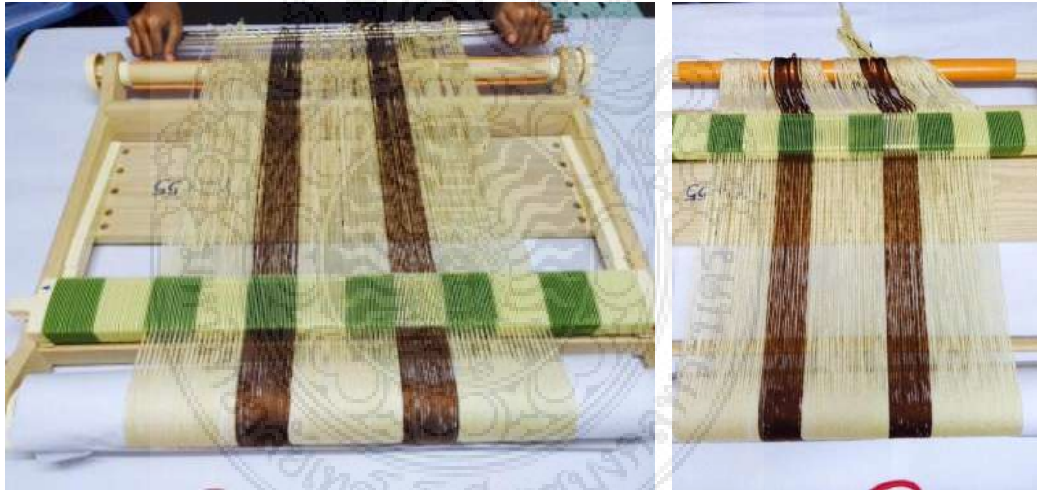
ภาพที่ 3.16 การโยงเส้นด้ายขั้นตอนที่ 10
