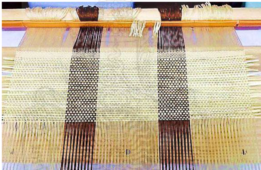
ภาพที่ 4.6 การทอด้วยเส้นใยจากชงข้าว
