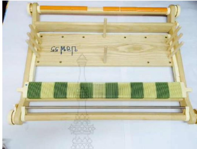
ภาพที่ 3.7 การโยงเส้นด้ายขั้นตอนที่ 1
