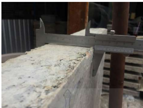
รูปที่ 4.3 การวัดขนาดของผนังคอนกรีตสำเร็จรูปมวลเบาเสริมแผ่นโพนอัดแน่นด้วยเวอร์เนียคาลิเปอร์
