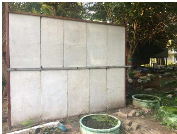
รูปที่ 4.31 ผนังจำลองที่ก่อสร้างด้วยผนังคอนกรีตสำเร็จรูปมวลเบาเสริมแผ่นโฟมอัดแน่น
