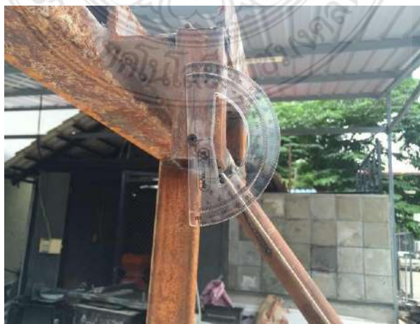
รูปที่ 3.12 อุปกรณ์วัดมุมของแท่นทดสอบความทนการกระแทก
