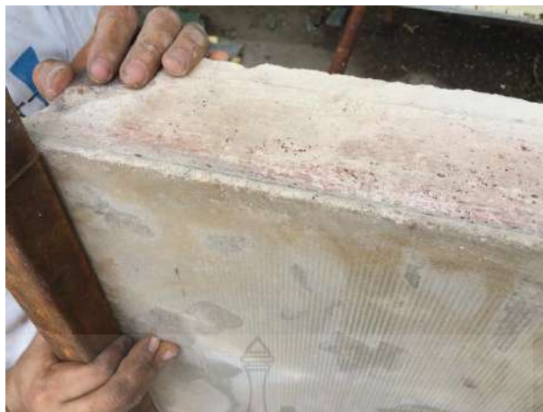
รูปที่ 4.6 การซึ่เส้นเอ็นในการวัดค่าการโก่งตัวของผนังคอนกรีตสำเร็จรูป
