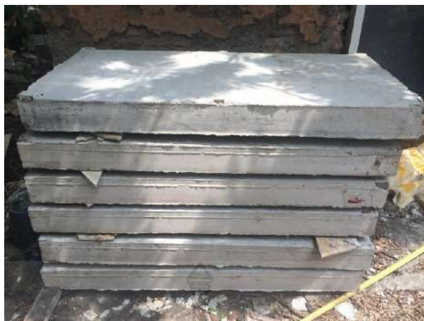
รูปที่ 3.37 การกองรวมผนังคอนกรีตสำเร็จรูปมวลเบาเสริมแผ่นโพลีเอทเธนเพื่อบ่มในอากาศ
