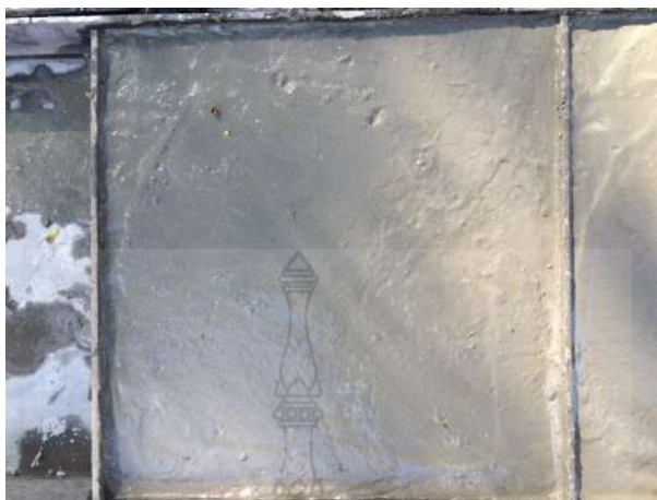
รูปที่ 3.56 ผนังคอนกรีตสำเร็จรูปที่มีการเสริมแผ่นโฟมขนาดเล็กสำหรับทดสอบสภาพการนำความร้อน
