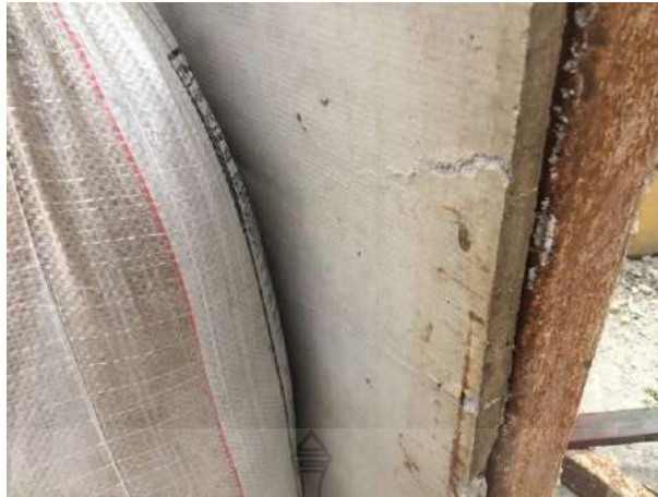
รูปที่ 13 ผนังคอนกรีตมวลเบาด้วยการเสริมแผ่นโฟมอัดแน่นที่ถูกวัสดุนุ่มขนาดใหญ่ กระแทกจนเกิดรอยร้าว
