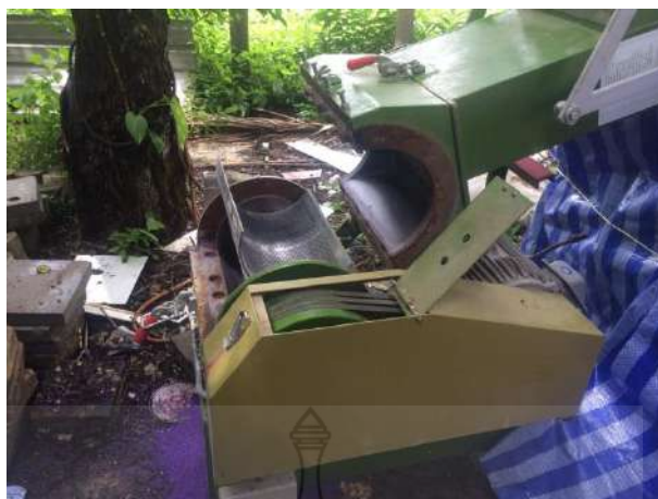
รูปที่ 3.15 การติดตั้งตะแกรงเบอร์ 4 ลงในเครื่องบดย่อยพลาสติก
