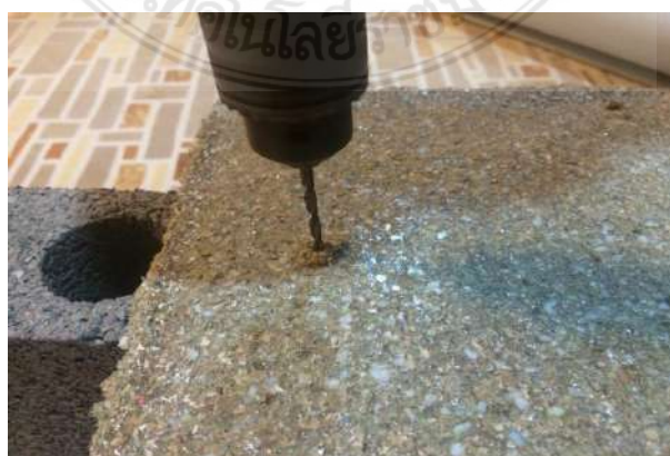
รูปที่ 4.17 การทดสอบเจาะแผ่นไม้เทียมจากเศษกระดากกล่องนมผสมเศษพลาสติก PET ด้วยสว่านไฟฟ้า
