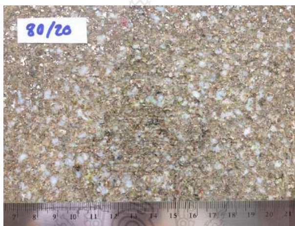
รูปที่ 4.1 ลักษณะโดยทั่วไปของแผ่นไม้เทียมจากขยะกล่องนมผสมเศษพลาสติก PET อัตราส่วน 80:20
