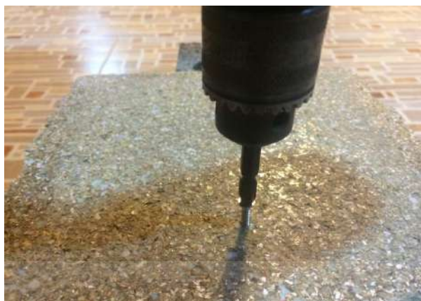
รูปที่ 4.18 การขันตะปูเกลียวปลายปล่อยลงในแผ่นไม้เทียมจากเศษกระดาษกล่องนมผสมเศษพลาสติก PET ด้วยสว่านไฟฟ้า
