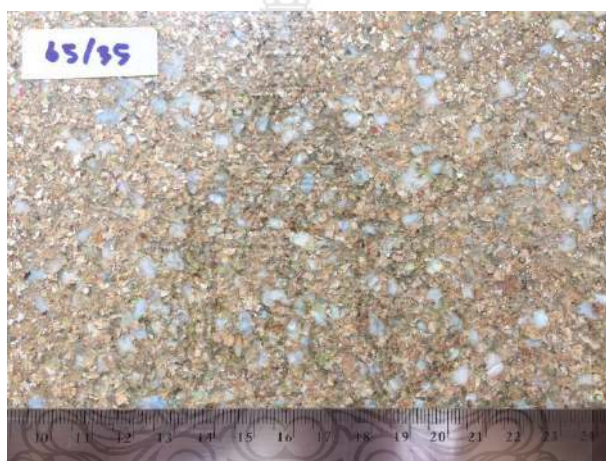
รูปที่ 4.4 ลักษณะโดยทั่วไปของแผ่นไม้เทียมจากขยะกล่องนมผสมเศษพลาสติก PET อัตราส่วน 65:35
