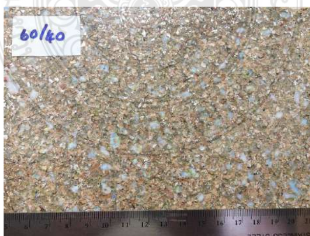
รูปที่ 4.5 ลักษณะโดยทั่วไปของแผ่นไม้เทียมจากขยะกล่องนมผสมเศษพลาสติก PET อัตราส่วน 60:40
