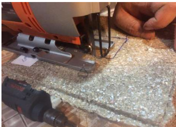
รูปที่ 3.34 การตัดแผ่นไม้เทียมจากเศษกระดาษกล่องนมผสมเศษพลาสติก PET เพื่อทดสอบความต้านทานแรงดึงตั้งฉากกับผิวหน้า
