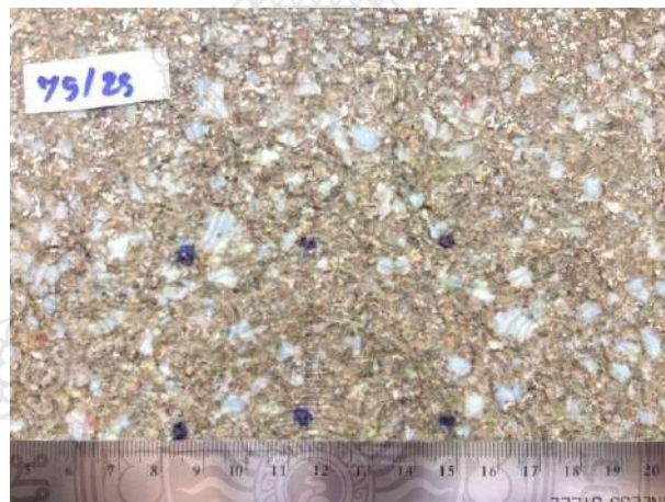
รูปที่ 16 ลักษณะโดยทั่วไปของแผ่นไม้เทียมจากขยะกล่องนมผสมเศษพลาสติก PET อัตราส่วน 75:25
