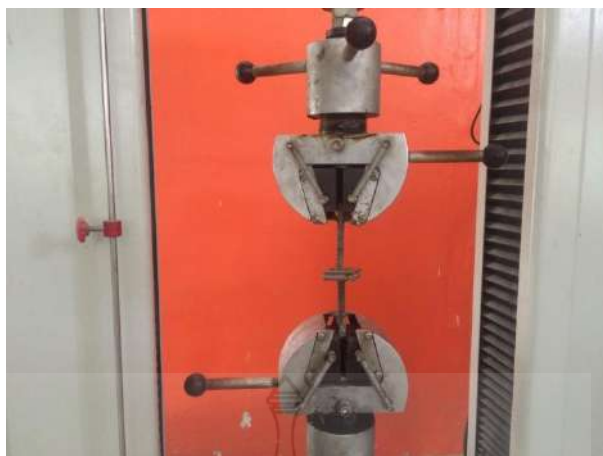
รูปที่ 3.37 การทดสอบความต้านทานแรงดึงตั้งฉากกับผิวหน้าของแผ่นไม้เทียม จากเศษกระดาษกล่อนมผสมเศษพลาสติก PET
