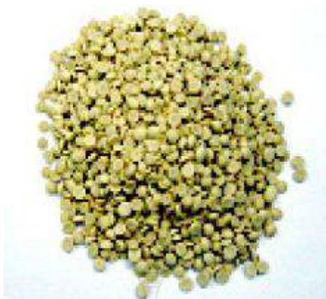
รูปที่ 2.13 เม็ดผสมของไม้พลาสติก (ธนดล, 2545)
