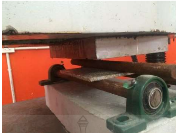
รูปที่ 10 การนำแผ่นไม้เทียมจากเศษกระดาษกล่อนมผสมเศษพลาสติก PET เข้าเครื่อง UTM
