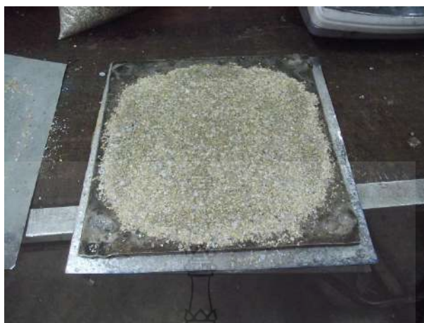
รูปที่ 3.26 แผ่นไม้เทียมจากเศษกระดาษกล่องนมผสมเศษพลาสติก PET ที่อัดขึ้นรูปแล้ว
