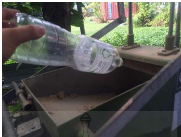
รูปที่ 3.18 การใส่ขวดพลาสติกโพลิเอทิลีนเทเรฟทาเลต (PET) ลงในเครื่องบดย่อยเพื่อลดขนาด
