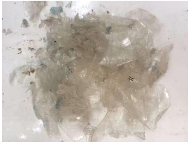
รูปที่ 4 เศษขวดพลาสติกโพลิเอทิลีนเทเรฟทาเลต (PET) ที่บดย่อยแล้ว
