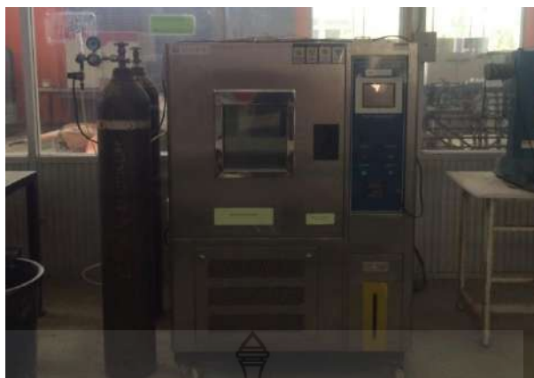
รูปที่ 3.13 ตู้อบและไล่ความชื้นแบบปรับอุณหภูมิได้
