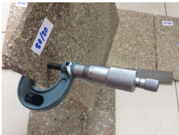
รูปที่ 3.31 การวัดการพองตัวของแผ่นไม้เทียมจากเศษกระดาษกล่อนผสมเศษพลาสติก PET ด้วยไมโครมิเตอร์
