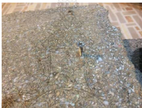
รูปที่ 4.19 แผ่นไม้เทียมจากเศษกระดาษกล่องนมผสมเศษพลาสติก PET ที่ยึดด้วยตะปูเกลียวปลายปล่อย
