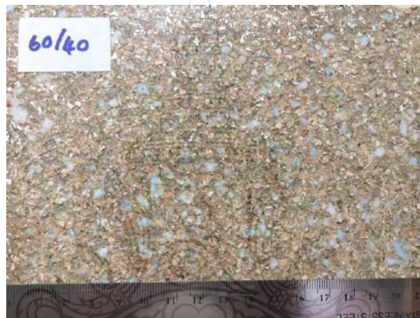
รูปที่ 19 ลักษณะโดยทั่วไปของแผ่นไม้เทียมจากขยะกล่องนมผสมเศษพลาสติก PET อัตราส่วน 60:40
