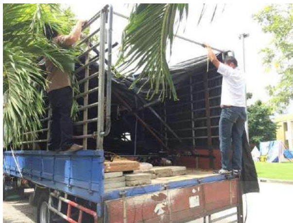
รูปที่ 4.32 การคลุมกระบะของรถบรรทุก 6 ล้อ ด้วยผ้าใบขณะทำการขนส่งโครงสร้างบ้านถอดประกอบ
