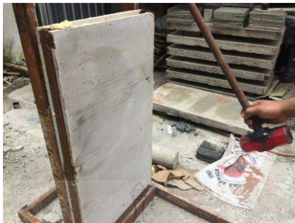
รูปที่ 3.53 การยกตุ้มน้ำหนักให้ได้มุมและระดับตามที่มาตรฐานกำหนด
