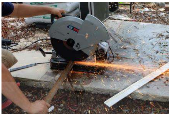
รูปที่ 3.3 การตัดเหล็กแผ่นให้ได้ขนาด 50 x 50 มิลลิเมตร หนา 4 มิลลิเมตร ตามต้องการ
