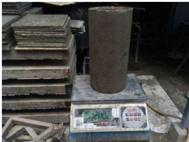
รูปที่ 3.51 การชั่งน้ำหนักแท่งมอร์ตาร์ทรงกระบอกภายหลังจากการแช่น้ำ
