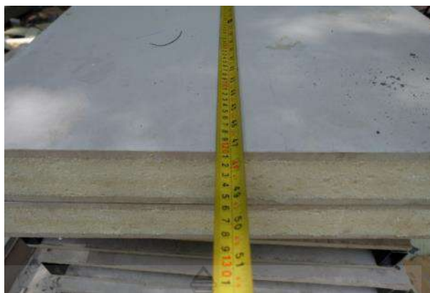
รูปที่ 4.3 การวัดขนาดความยาวของผนังคอนกรีตสำเร็จรูปมวลเบาด้วยวิธีฉีดยาโฟมเป็นแกนกลาง
