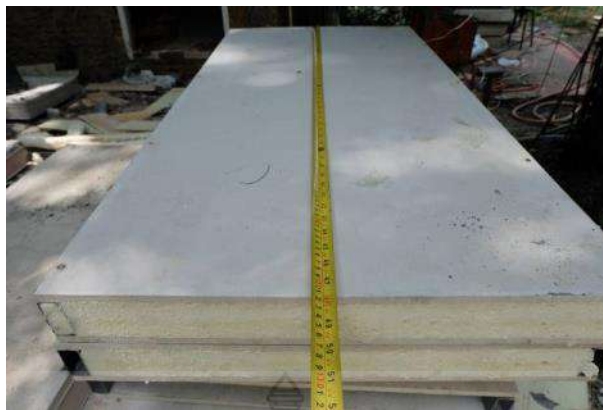
รูปที่ 3.46 การวัดขนาดของผนังคอนกรีตสำเร็จรูปมวลเบาด้วยเทคนิคการฉีดยา เป็นแกนกลางผนัง
