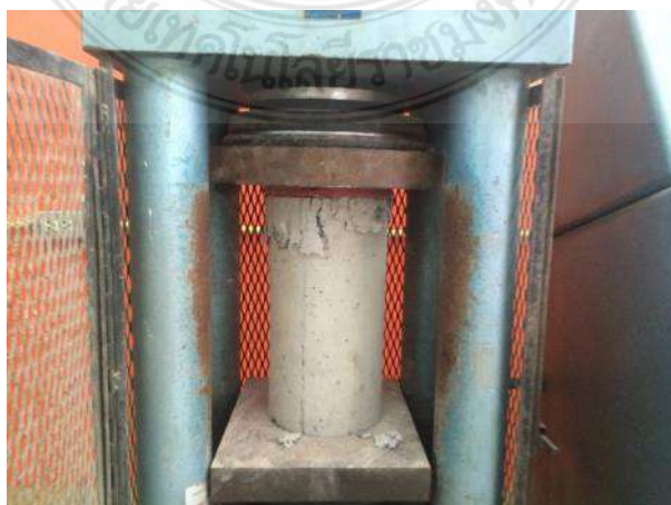
รูปที่ 3.48 ลักษณะของแท่งมอร์ตาร์ทรงกระบอกที่เสียหายจากการทดสอบความต้านทานแรงอัด
