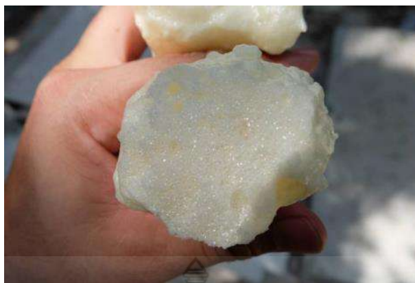
รูปที่ 3.43 โฟมส่วนเกินที่ตัดออกจากผนังสำเร็จรูป
