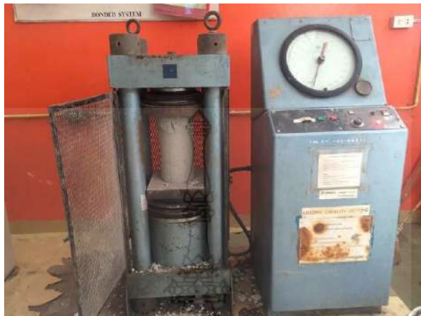
รูปที่ 10 การทดสอบความต้านทานแรงอัดของแท่งมอร์ตาร์ทรงกระบอก
