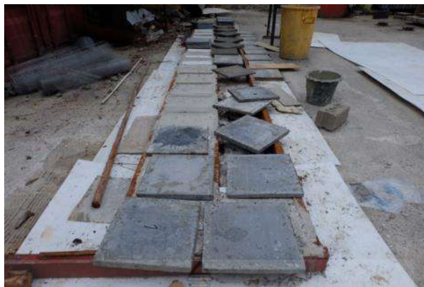
รูปที่ 3.58 แผ่นมอร์ตาร์สำหรับทดสอบความต้านทานแรงดัด
