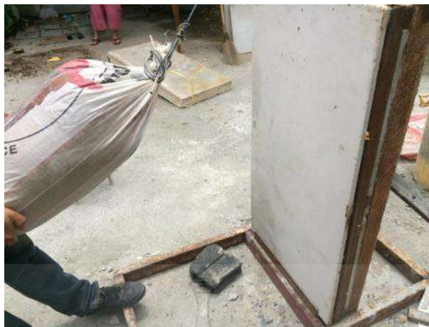
รูปที่ 3.56 การปล่อยวัสดุนุ่มให้กระแทกผนังคอนกรีตสำเร็จรูปตามที่มาตรฐานกำหนด
