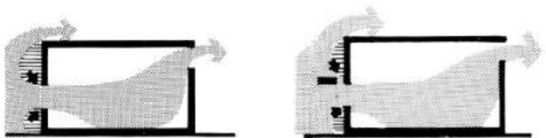
ภาพที่ 2.7 แสดงการเปิดช่องเปิดเพื่อให้อากาศผ่านในระดับความสูงร่างกาย
