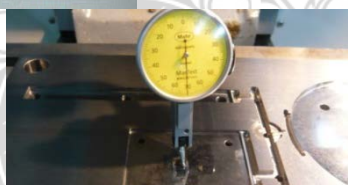
ภาพที่ 30 แสดงภาพการวัดขนาดความลึก 2.0 มม. วัดได้ 2.05 มม.
