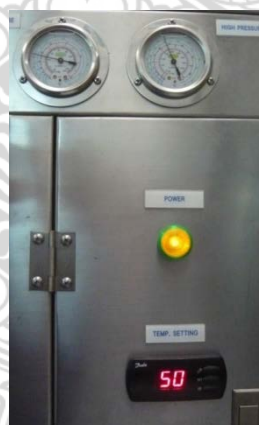
ภาพที่ 15 แสดงภาพเครื่องควบคุมอุณหภูมิแม่พิมพ์ฉีดพลาสติกPET
