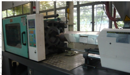
ภาพที่ 1 แสดงเครื่องฉีดพลาสติก Jetmaster C Serie JM168-C/ES
