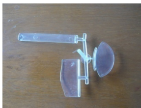
ภาพที่ 19 แสดงผลการฉีด PET เงื่อนไขที่ 1
