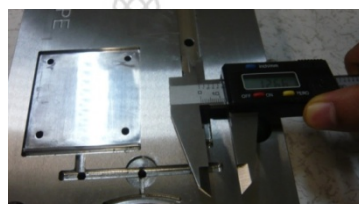
ภาพที่ 33 แสดงภาพการวัดขนาดความกว้างขนาด 12.7x127 มม.
