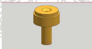
ภาพที่ 3.39 แสดงภาพปลอกกรูนิด (Spure Bush)
