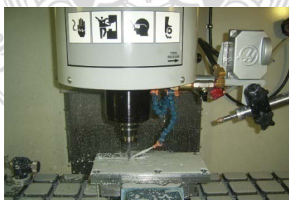
ภาพที่ 3.43 แสดงภาพการขึ้นรูป Cavity Plate HDPE
