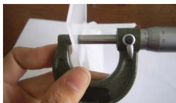
ภาพที่ 28 แสดงภาพการวัดขนาดความหนาของชิ้นงาน
