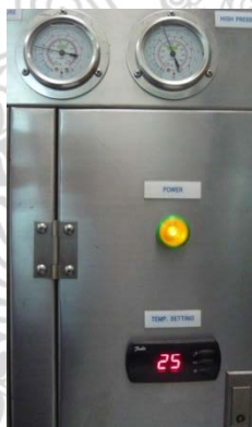
ภาพที่ 8 แสดงภาพเครื่องควบคุมอุณหภูมิแม่พิมพ์ฉีดพลาสติกHDPE
