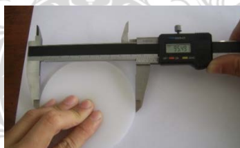
ภาพที่ 26 แสดงภาพการวัดขนาดความโตของชิ้นงาน
