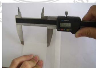
ภาพที่ 27 แสดงภาพการวัดขนาดความกว้างของชิ้นงาน
