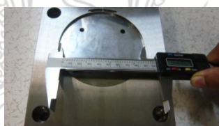
ภาพที่ 34 แสดงภาพการวัดขนาดความโต 100x100 มม.
