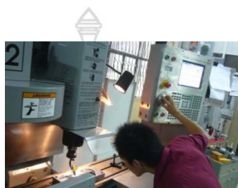
ภาพที่ 28 แสดงภาพการวัดขนาดความหนาของชิ้นงาน
