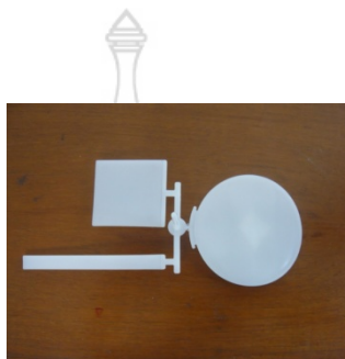
ภาพที่ 10 แสดงชิ้นงานที่ได้จากการฉีด HDPE
