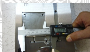
ภาพที่ 35 แสดงภาพการวัดขนาดความกว้างขนาด 60x60 มม.
