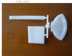
ภาพที่ 9 แสดงชิ้นงานที่ได้จากการฉีด HDPE ครั้งแรก
