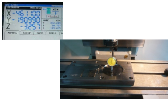
ภาพที่ 32 แสดงภาพการวัดขนาดความลึก 3.2 มม. วัดได้ 3.257 มม.
