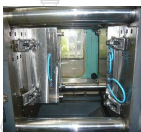
ภาพที่ 25 แสดงภาพแม่พิมพ์ขณะเปิดและปลดPET
