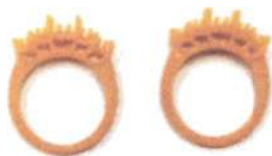
รูปที่ 3.6 ต้นแบบแว็กซ์ EC500 ที่ได้จากเครื่อง RP
