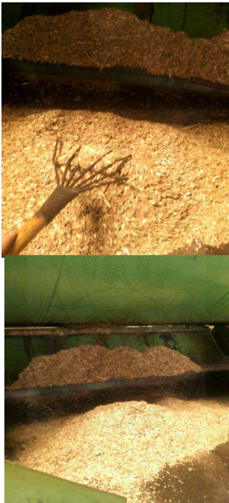
ภาพที่ 17 การผสมกาวตามสูตรที่เตรียมไว้และทำการชั่งน้ำหนักวัสดุพร้อมนำไปโรยแผ่นในแบบแม่พิมพ์
