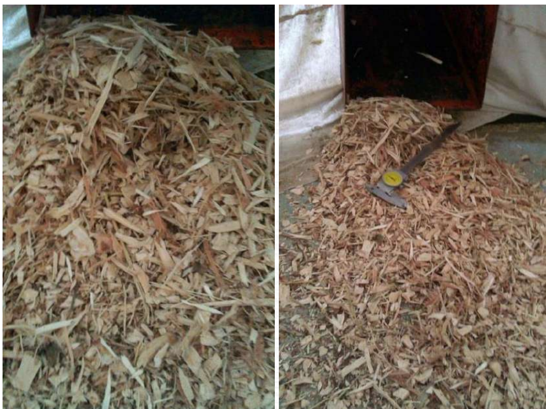
ภาพที่ 4 แสดงผลการทดลองการสับบดย่อยท่อนวัสดุจากการเข้างานไม้ทั้ง 3 ขนาดด้วยเครื่องสับบดย่อยด้วย Hammer Mill ขนาด 7 แรงม้า ของบริษัทฯ ไม่สามารถทำการสับบดย่อยได้ดี
