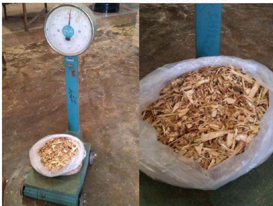
ภาพที่ 4 แสดงผลการทดลองการสับบดย่อยท่อนวัสดุจากการเข้างานไม้ทั้ง 3 ขนาดด้วยเครื่องสับบดย่อยด้วย Hammer Mill ขนาด 7 แรงม้า ของบริษัทฯ ไม่สามารถทำการสับบดย่อยได้ดี
