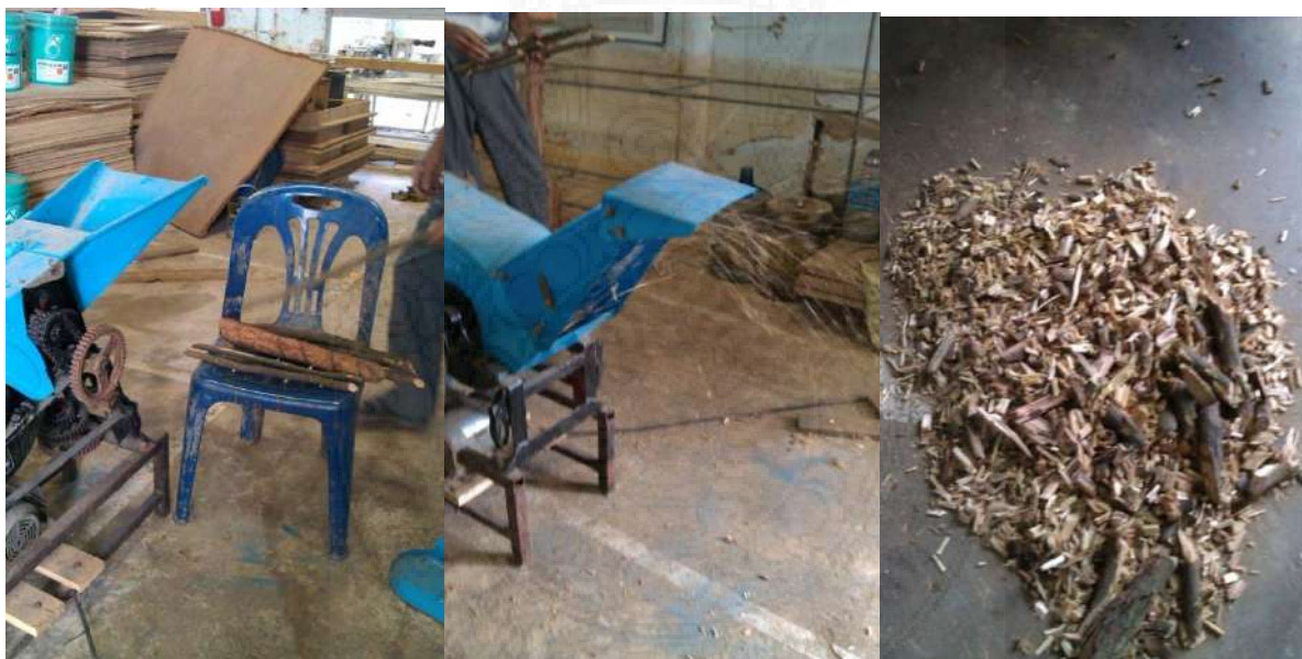
ภาพที่ 7 การจัดหาเครื่องสับบดย่อยใหม่เพื่อใช้ทดลองสับบดย่อยเศษวัสดุจากการใช้งานไม้ มีขนาดมอเตอร์ 3 แรงม้า เครื่องสับบดย่อยใหม่เพื่อความเหมาะสมกับชนิดของวัสดุ
