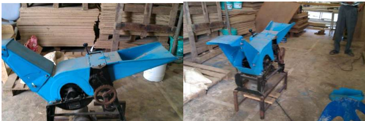
ภาพที่ 6 การจัดหาเครื่องสับบดย่อยใหม่เพื่อใช้ทดลองสับบดย่อยเศษวัสดุจากการใช้งานไม้ มีขนาดมอเตอร์ 3 แรงม้า เครื่องสับบดย่อยใหม่เพื่อความเหมาะสมกับชนิดของวัสดุ
