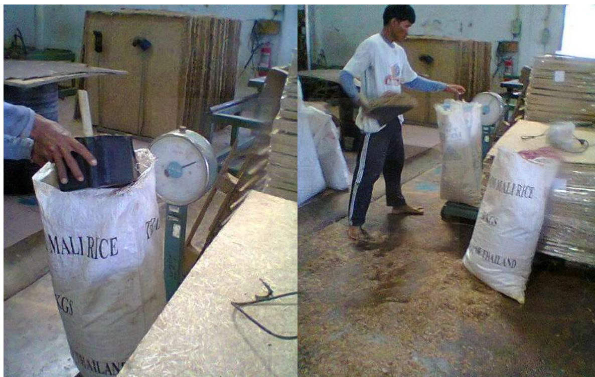
ภาพที่ 15 การชั่งน้ำหนักวัสดุและชั่งน้ำหนักภาตามสูตรที่เตรียมไว้เตรียมพร้อมในกระบวนการผลิตขั้นต่อไป
