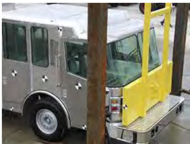
รูปที่ 1.4 การทดสอบการกระแทกด้านหน้าตามมาตรฐาน ECE R29
