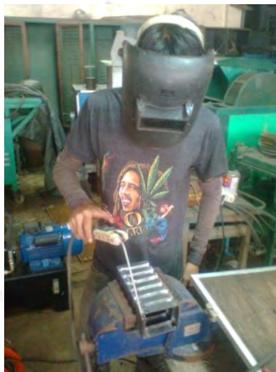
รูปที่ 3.13 การเชื่อมโครงสร้างกันแรงกระแทก
