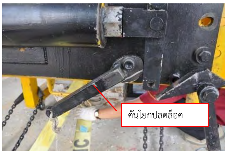
รูปที่ 3.28 การตั้งกลไกปลดล็อกค้อนน้ำหนัก
