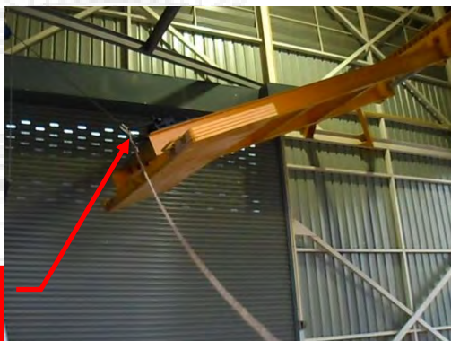
รูปที่ 7 การกระตุกกลไกเพื่อปลดตะขอตัวที่ 2
