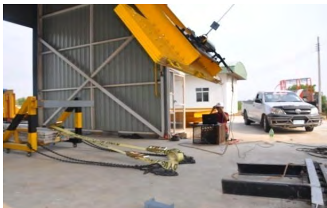
รูปที่ 3.30 การยกลูกตุ้มด้วยรอกไฟฟ้า
