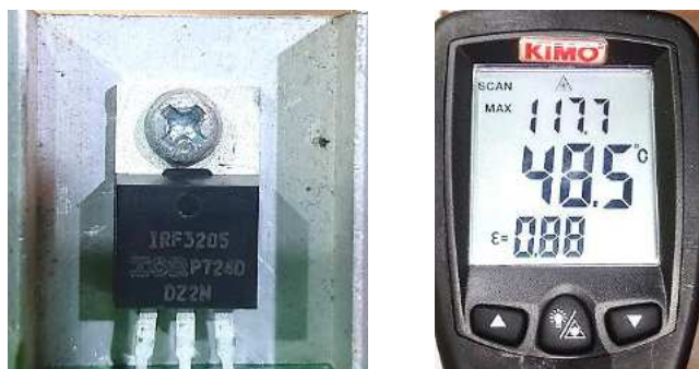
ภาพที่ 4.13 การทดสอบอุณหภูมิเฟาเวอร์มอสเฟตตำแหน่งที่ 2 ของวงจรขยายสัญญาณ Pcb รุ่นใหม่ใช้เฟาเวอร์มอสเฟต ir F3205 [11]
