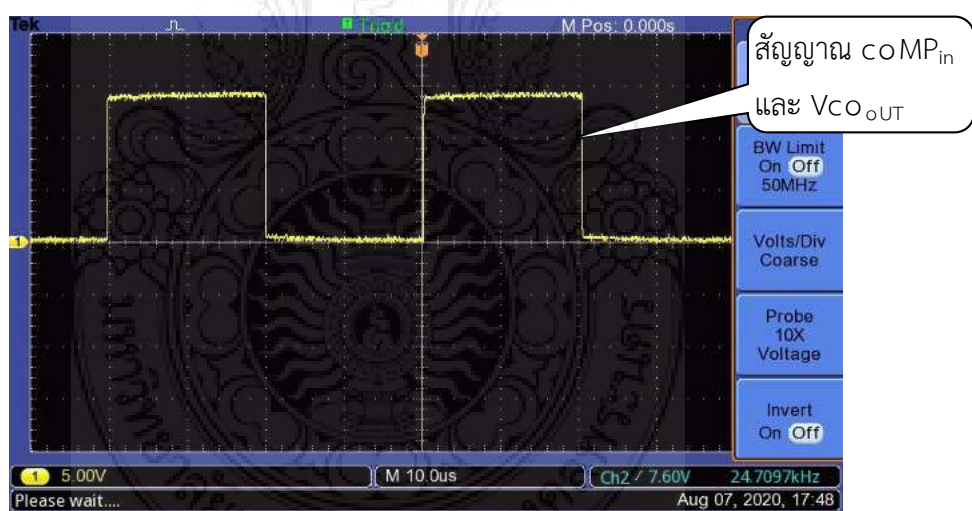
ภาพที่ 4.8 สัญญาณวัดที่ขา 3 , 4 ( coMP_{in} , Vco_{oUT} ) ของไอซีเบอร์ 4046b เทียบกับขา 8 ( V_{ss} )
