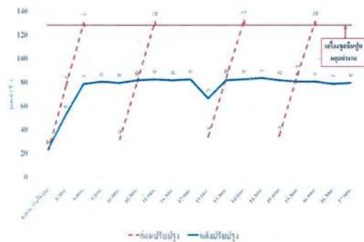
รูปที่ 11 ระยะเวลาที่เครื่องชุดหุนปืนทำงานได้ก่อนและหลังการปรับปรุง
