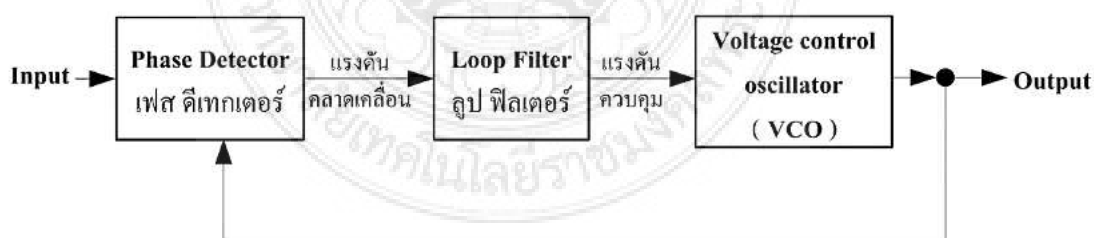
ภาพที่ 2.9 แผนผังบล็อกไดอะแกรมของเฟสล็อกกลุ๊ป [5]
