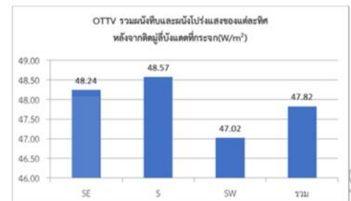
รูปที่ 7 ผลการคำนวณค่า OTTV ใหม่จากการติดมู่ลี่
