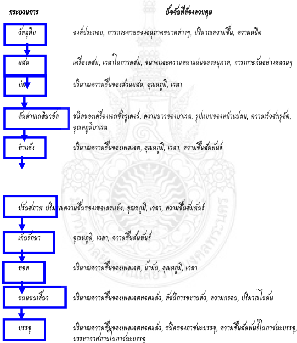
แผนภาพที่ 1 กระบวนการทางเทคโนโลยีเอกซ์ทรูชัน และปัจจัยที่ต้องควบคุมตั้งแต่การเตรียมวัตถุดิบจนบรรจุ
