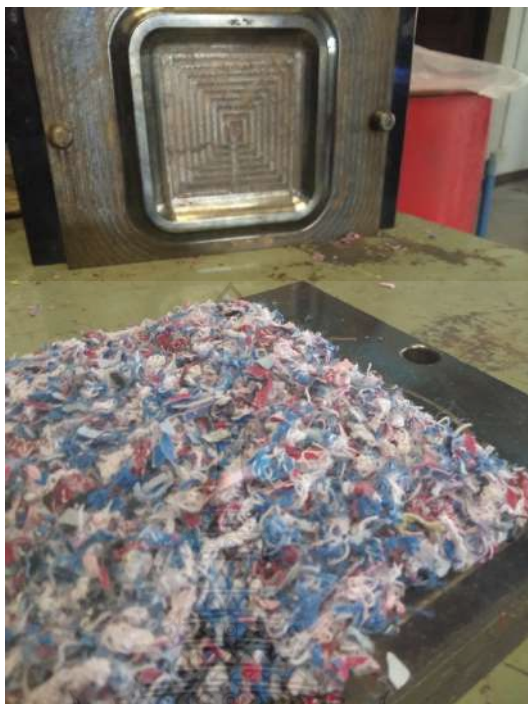
ภาพที่ 33 การเรียงเศษด้ายพอลิเอสเตอร์สำหรับขึ้นรูปผลิตภัณฑ์
