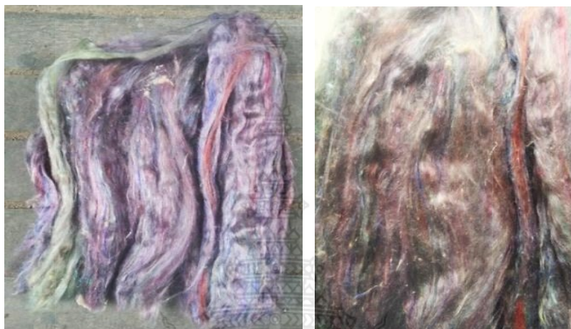
ภาพที่ 3 เศษวัสดุเหลือทิ้งที่ผ่านเข้าเครื่อง CARDING ในรูปแบบของเส้น SLIVER
