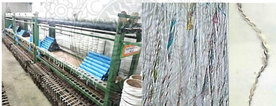
ภาพที่ 4 เครื่อง GAREBO ไทยนาโซค สำหรับปั่นเส้นด้ายพิเศษแบบ SLUB YARN และเส้นด้ายพิเศษแบบ SLUB YARN
