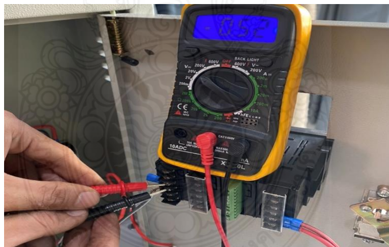
ภาพที่ 3.12 การวัดกระแสไฟโดยใช้มัลติมิเตอร์
