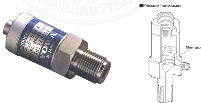
ภาพที่ 2.5 ทรานสดิวเซอร์ความดันชนิดสเตรนเกจ [7]
