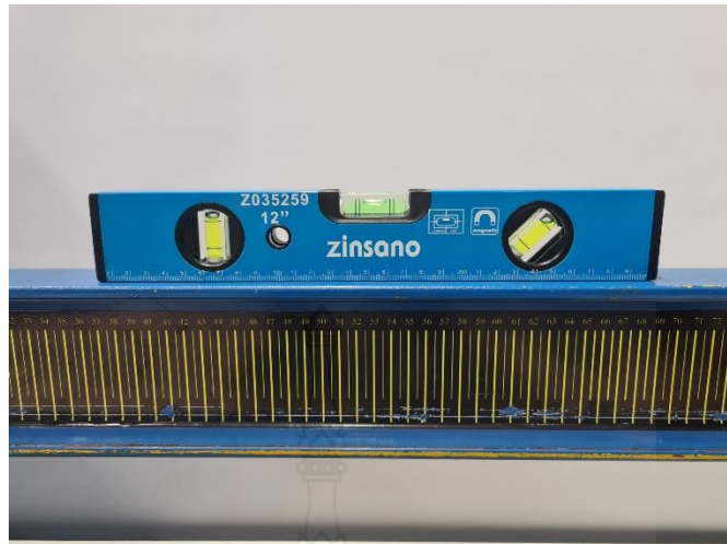
ภาพที่ 3.6 การปรับระดับคานของชุดสาธิตฯ
