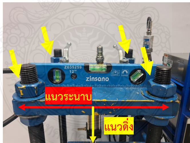
ภาพที่ 3.7 การปรับระดับกระบอกสูบ
