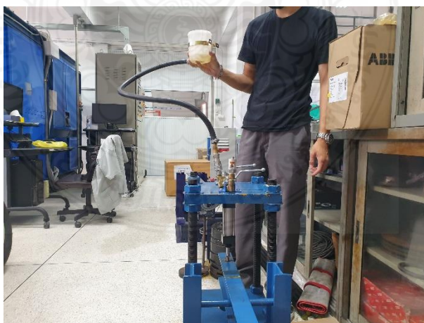
ภาพที่ 4.8 การไล่อากาศออกจากระบบไฮดรอลิก
