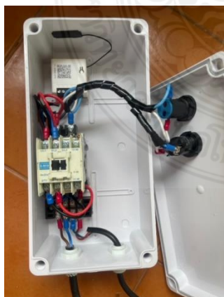
รูประบบวงจรการควบคุมชุดปั้มน้ำ
