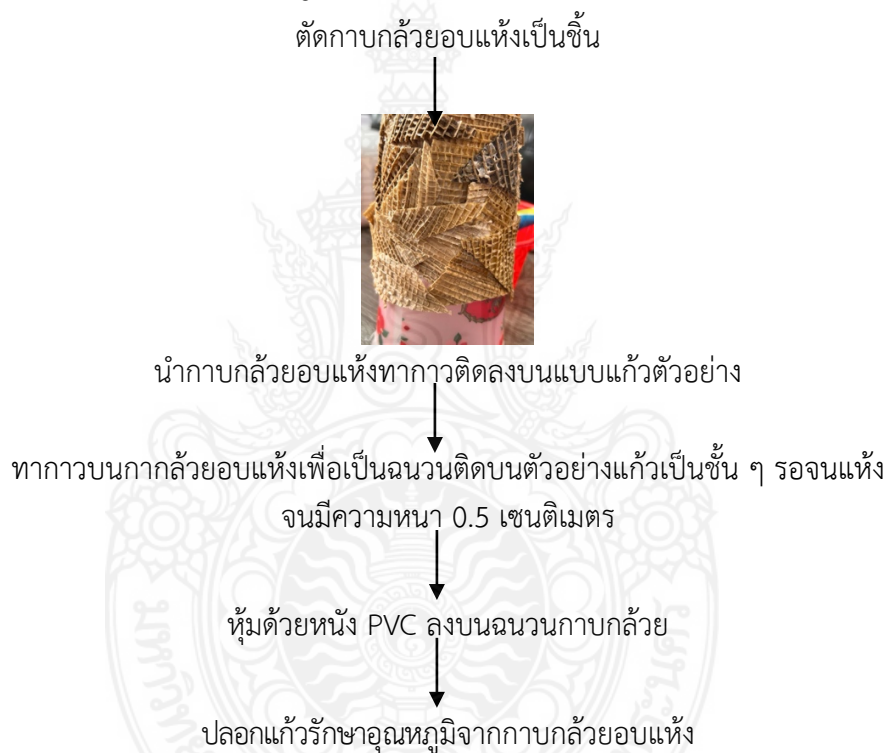
แผนภาพที่ 3.2 กรรมวิธีการผลิตปลอกรักษาอุณหภูมิจากกากกล้วยอบแห้งของแบบที่ 1
