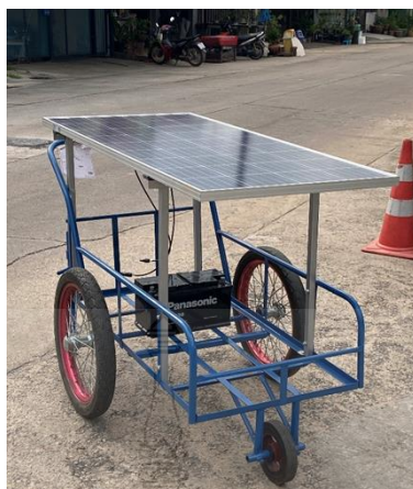
รูปที่ 3.4 การติดตั้งแผงพลังงานแสงอาทิตย์บนตัวรถเข็น
