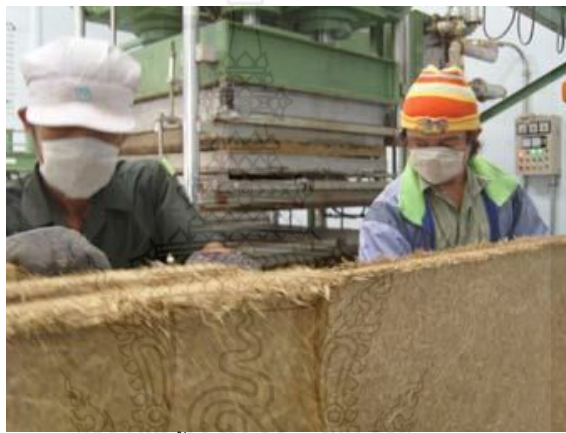
ภาพ 2.13 ขั้นตอนการนำวัสดุที่อัดเสร็จมาฟุ้งตาก
