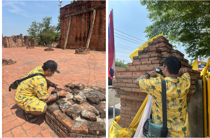
ภาพที่ 142 ใช้เครื่องมือวัดค่าสีบริเวณศาสนสถาน ที่มา: สุนทร บินกาซานิ (2567)
