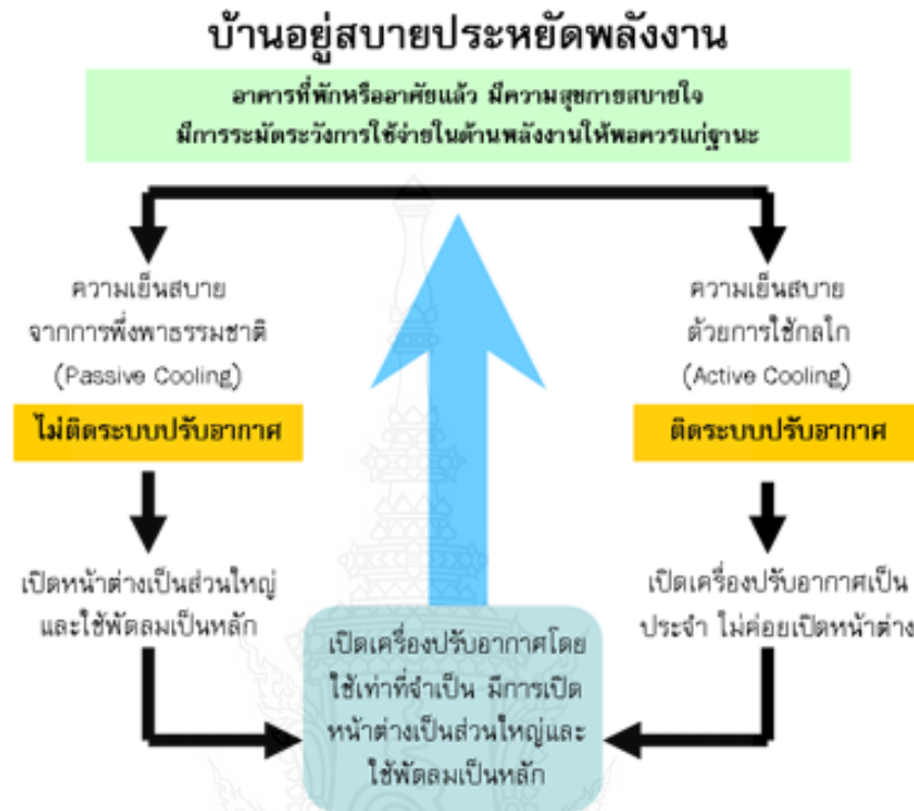
ภาพที่ 2.26 แนวความคิดและหลักการออกแบบบ้านอยู่สบายประหยัดพลังงาน
