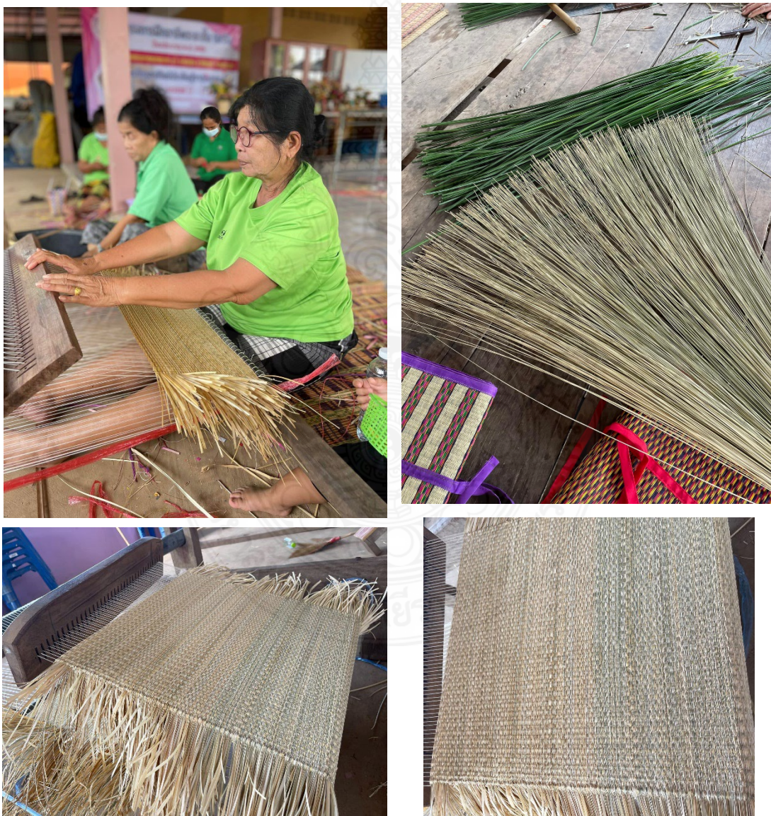
ภาพที่ 4.9 กระบวนการทอ กก และหญ้าแฝก ผสมกัน
