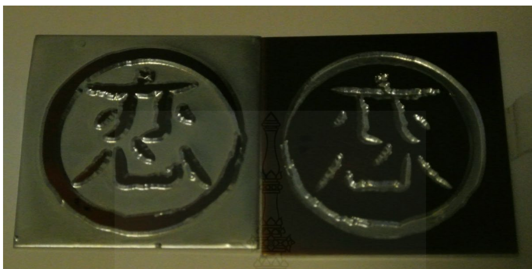
ภาพที่ 4.21 แสดงการแม่พิมพ์สำหรับอัดลาย
