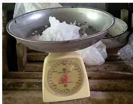
ภาพที่ 4.2 การต้มเยื่อหญ้าแฝก และการตวงโซดาไฟที่ใช้ต้มเยื่อ
