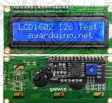
รูปที่ 2-22 โมดูลจอ LCD ที่ใช้การเชื่อมต่อแบบอนุกรม (ใช้ I2C LCD Controller เป็นตัวกลางในการเชื่อมต่อ)
