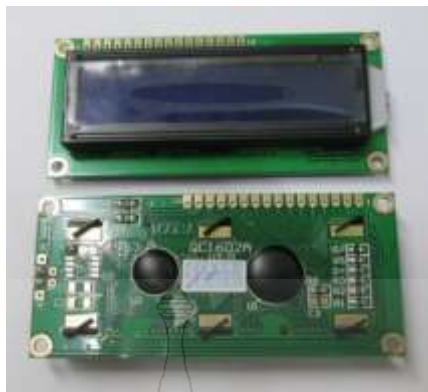
รูปที่ 2-21 โมดูลจอ LCD ที่ใช้การเชื่อมต่อแบบขนาน (ไม่ได้ใช้ I2C LCD Controller)
