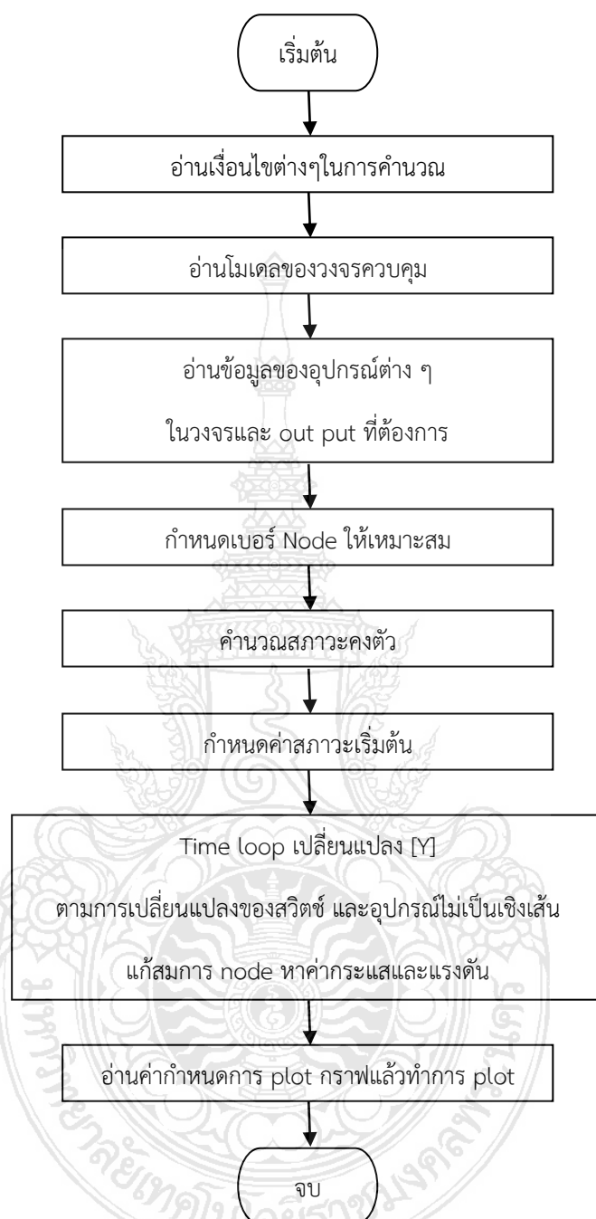
ภาพที่ ๓-๓ โฟลว์ชาร์ทการทำงานของโปรแกรม EMTP/ATP
