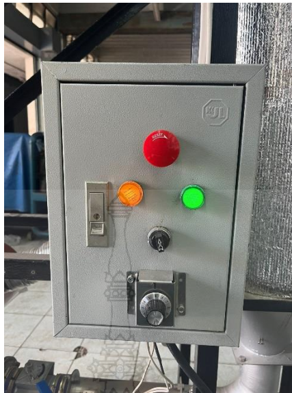
รูปที่ 3.7 ชุดควบคุมฮีตเตอร์และอุณหภูมิที่จะทำการอบ
