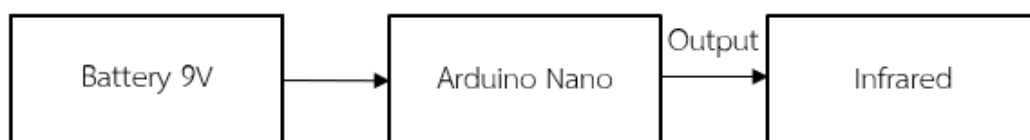
รูปที่ 3.6 รูปแบบการทำงานของรีโมทส่งสัญญาณ
