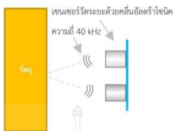
รูปที่ 2.16 การทำงานของเซ็นเซอร์วัดระยะด้วยคลื่นอัลตราโซนิก [14]
