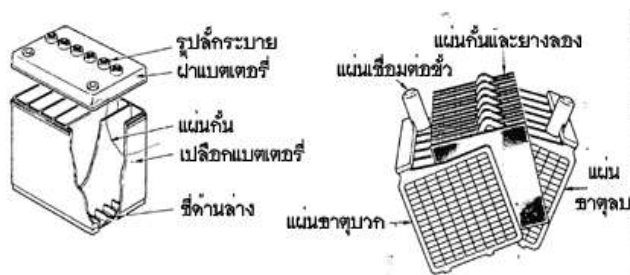
รูปที่ 2.10 โครงสร้างของแบตเตอรี่ [9]
