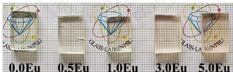
ภาพที่ 4.17 ลักษณะของแก้วตัวอย่าง LNKB ที่เจือด้วย Eu_2O_3
