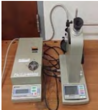
ภาพที่ 3.5 เครื่องวัดค่าดัชนีหักเห รุ่น DR-M2 บริษัท Atago
