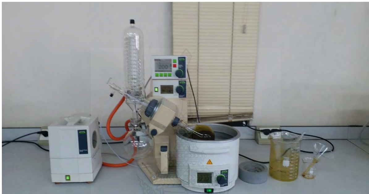
รูปที่ 3.5 การระเหยแยกตัวทำละลายด้วยเครื่องระเหยสุญญากาศแบบหมุน
