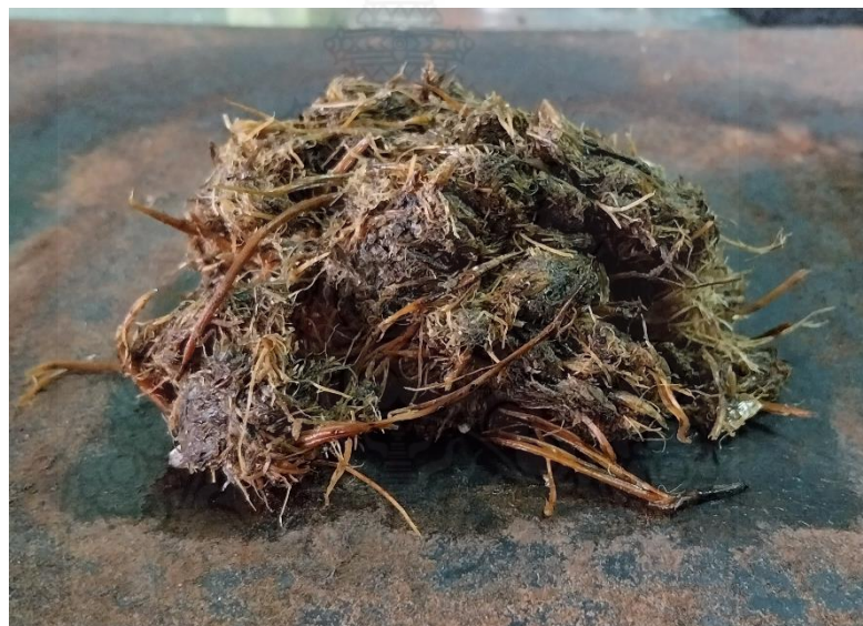
ภาพที่ 3.6 ก้อนเยื่อทะเลลายปาล์มน้ำมันที่ผ่านการคั้นรูป
