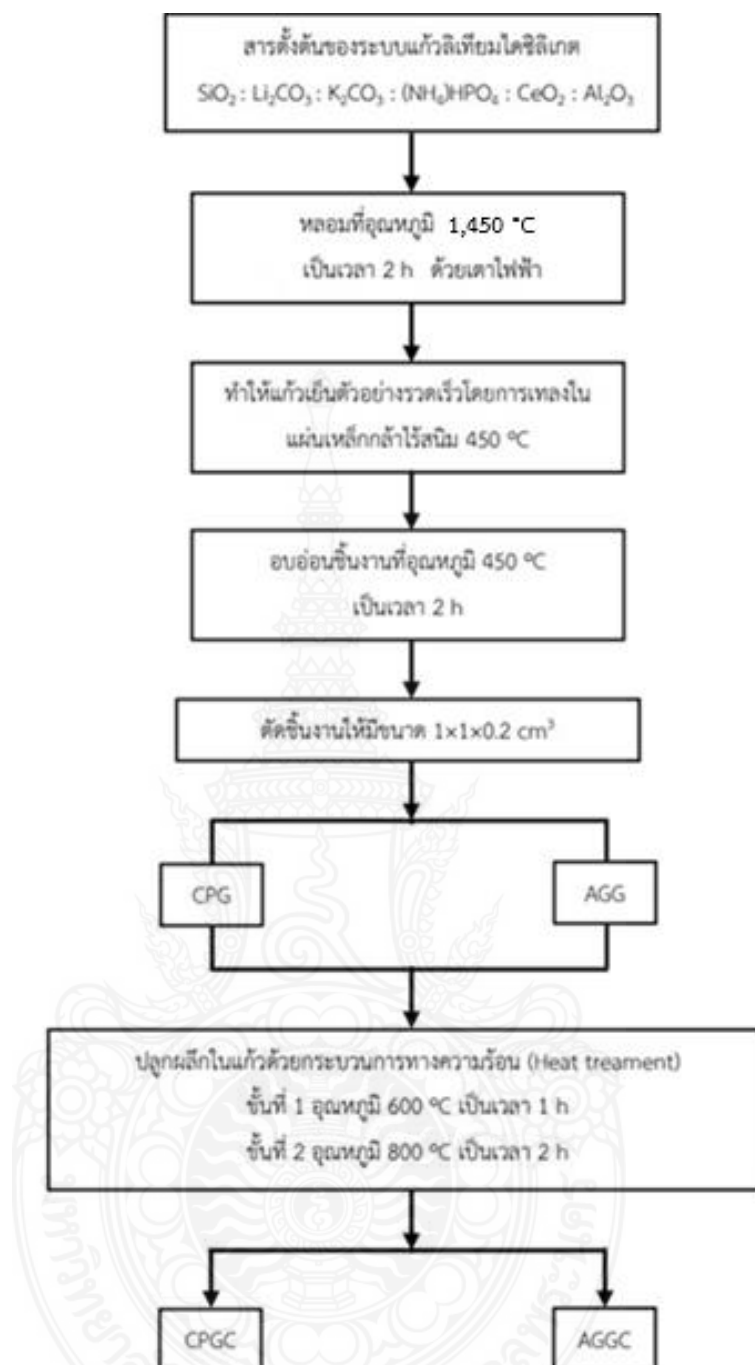
รูปที่ 3.2 แผนผังแสดงการเตรียมชิ้นงานแก้วเซรามิกลิเทียมไดซิลิเกตที่ใช้ซิลิกาจากกระบวนการแคลไซน์ (CPGC) และสารเคมีเกรดวิเคราะห์ (AGGC) เป็นสารตั้งต้น
