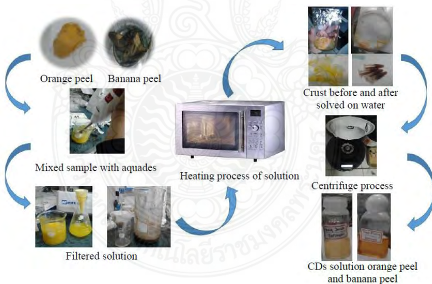
รูปที่ 4 แสดงขั้นตอนการสังเคราะห์คาร์บอนดอทด้วยเทคนิคไมโครเวฟ [3]
