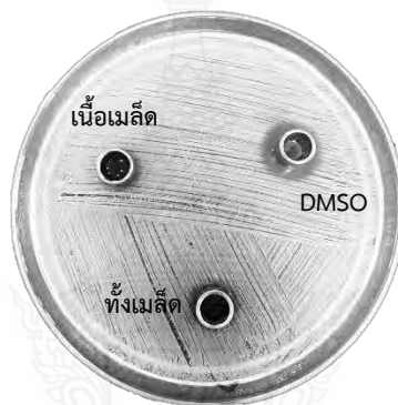
ภาพที่ 4.3 ตำแหน่งการทดสอบด้วยวิธีการแพร่กระจายผ่านวุ้นแบบจานทรงกระบอก
