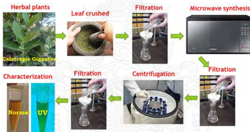
รูปที่ 5 การสังเคราะห์ (CQDs) จากสารสกัดใบพืชสมุนไพร Calotropis gigantea โดยวิธีไมโครเวฟ [11]
