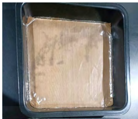
รูปที่ 3.8 แม่พิมพ์ที่ใช้ในการขึ้นรูปฟิล์มวัสดุเชิงประกอบระหว่างสตาร์ชจากแป้งข้าวโพดและสารเพิ่มเนื้อ
