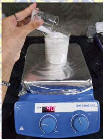
รูปที่ 3.7 ขั้นตอนการกวนผสมสตาร์ชจากแป้งข้าวโพด กลีเซอรอลและสารเพิ่มเนื้อด้วยเครื่องกวนแม่เหล็ก
