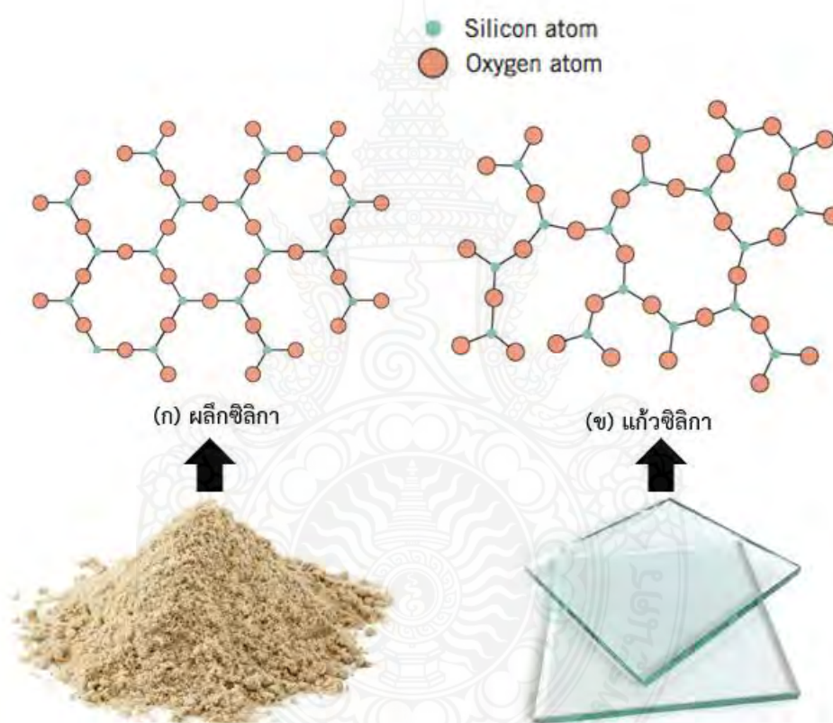
รูป 2.1 การเปรียบเทียบลักษณะโครงข่ายของวัสดุ (ก) ผลึกซิลิกา และ (ข) แก้วซิลิกา [ดัดแปลงจาก
