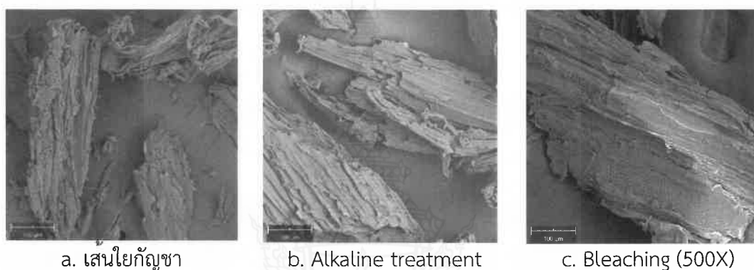
รูปที่ 13 ลักษณะของเส้นใยัญชาจากกระบวนการสกัดเส้นใย
