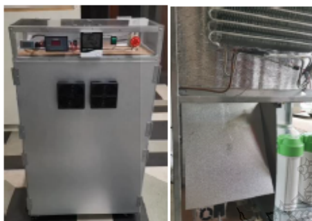
รูปที่ 3 เครื่องผลิตน้ำจากอากาศสำหรับการอุปโภคด้วยพลังงานสะอาดอย่างยั่งยืน ต้นแบบกรณีศึกษา
