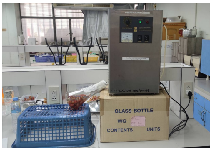
ภาพที่ 4.21 เครื่องผลิตโอโซนที่ได้มาตรฐาน ที่ใช้ผลิตโอโซนความเข้มข้น 0.375 กรัมต่อครึ่งชั่วโมง
