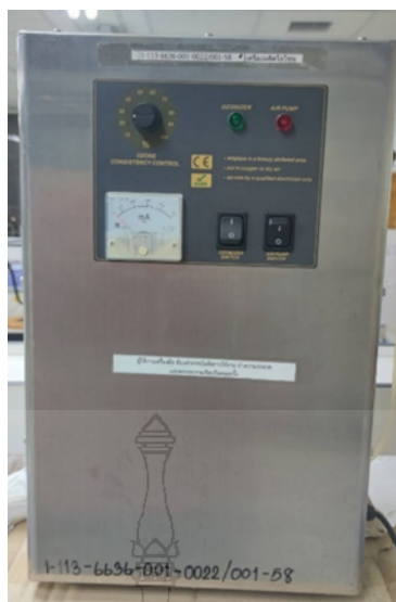
ภาพที่ 4.19 เครื่องผลิตโอโซนที่ได้มาตรฐาน 220 V ผลิตโอโซนที่ 3 กรัมต่อชั่วโมง
