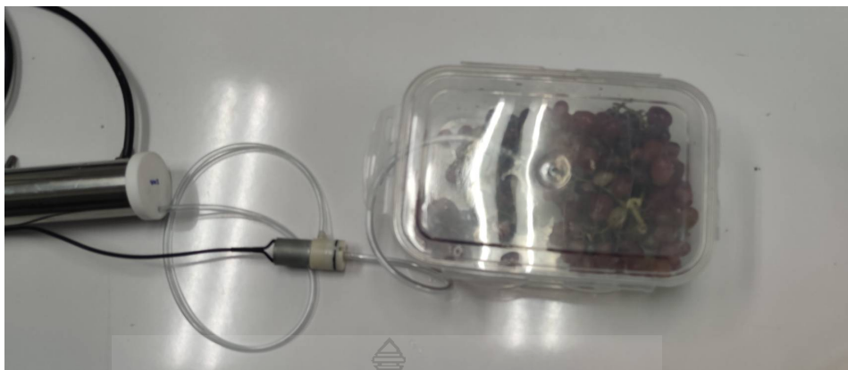
ภาพที่ 4.27 บั้มลมเพื่ออัดโอโซนให้อุ่นไขปลา
