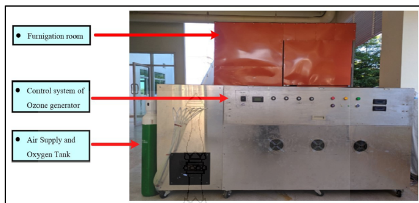
ภาพที่ 3.3 ระบบกำเนิดโอโซนความเข้มข้นเพื่อใช้กำจัดแมลงศัตรูพืชที่อยู่ในกล้วยไม้
