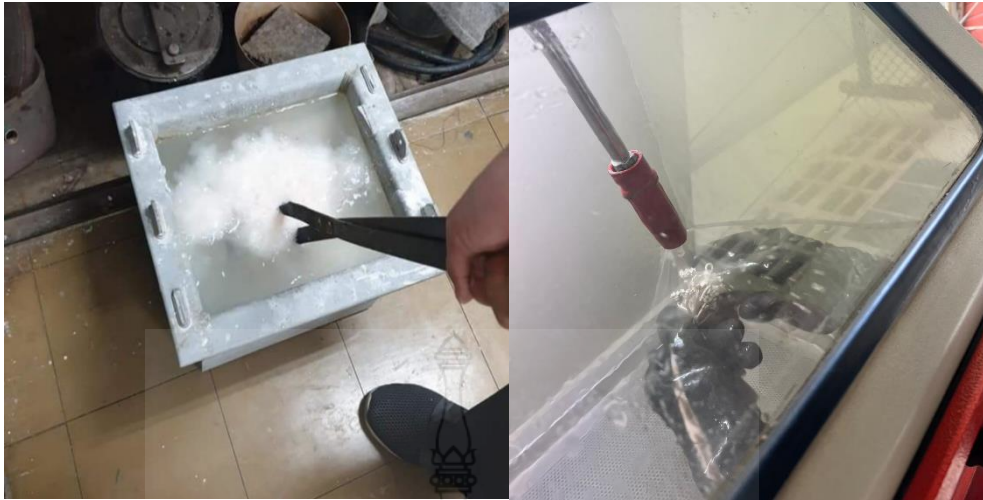
ภาพที่ ค.11 ภาพการแช่แข็งในถังน้ำ และการฉีบน้ำร้อนเพื่อล้างปูนในเบ้า
