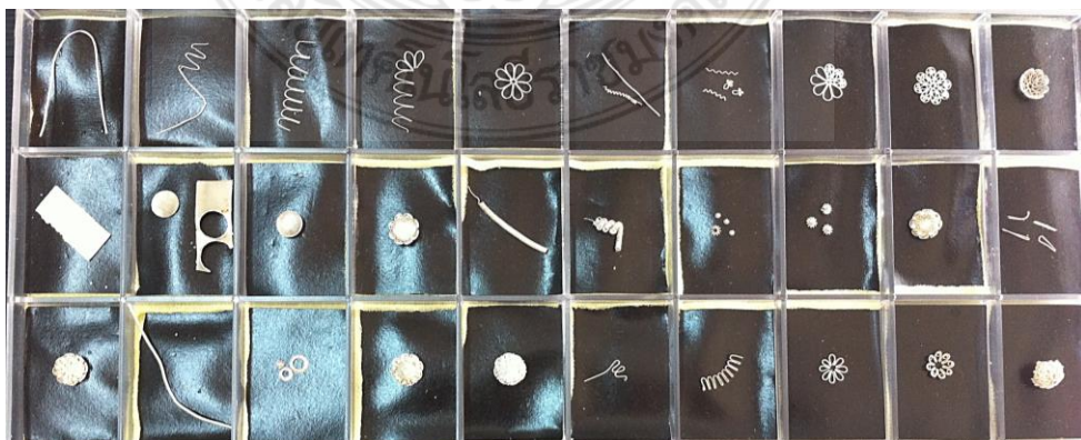
ภาพที่ 4.3 แสดงส่วนประกอบของกระบวนการผลิตเครื่องประดับ “กระดุม”
