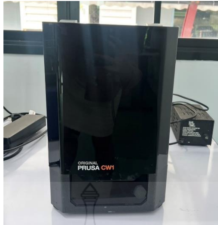
ภาพที่ ค.5 ภาพการอบชิ้นงานด้วยเครื่อง UV
