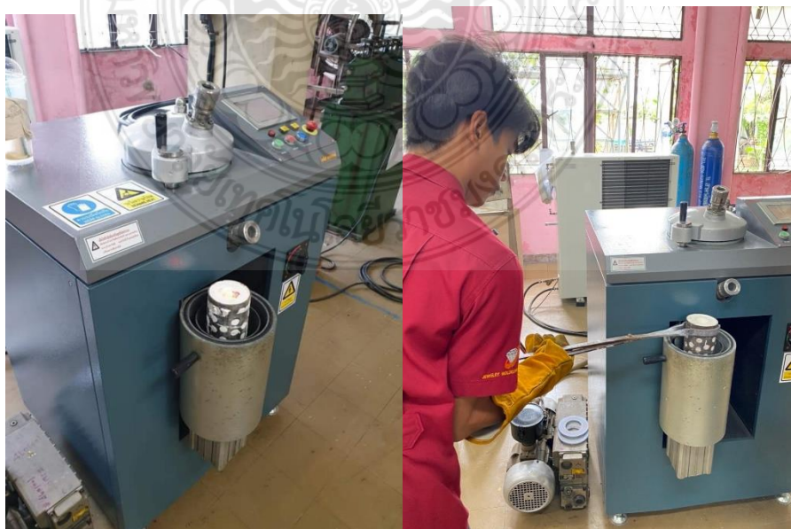
ภาพที่ ค.10 ภาพการหล่อด้วยเครื่องหล่อสุญญากาศ
