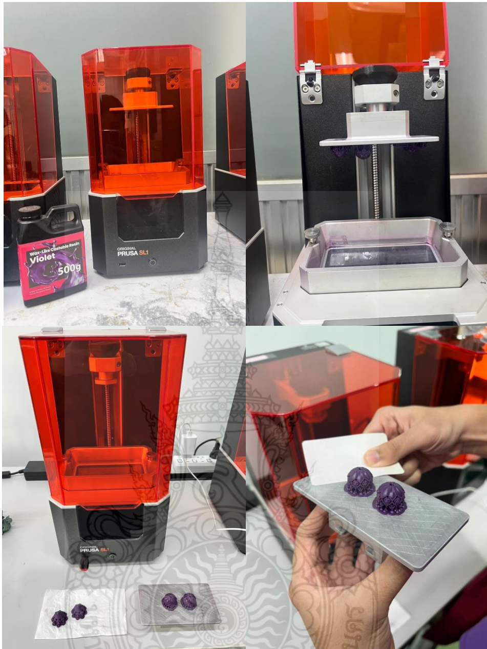
ภาพที่ ค.4 ภาพการสร้างต้นแบบอย่างรวดเร็วด้วยเครื่อง Rapid Prototype
