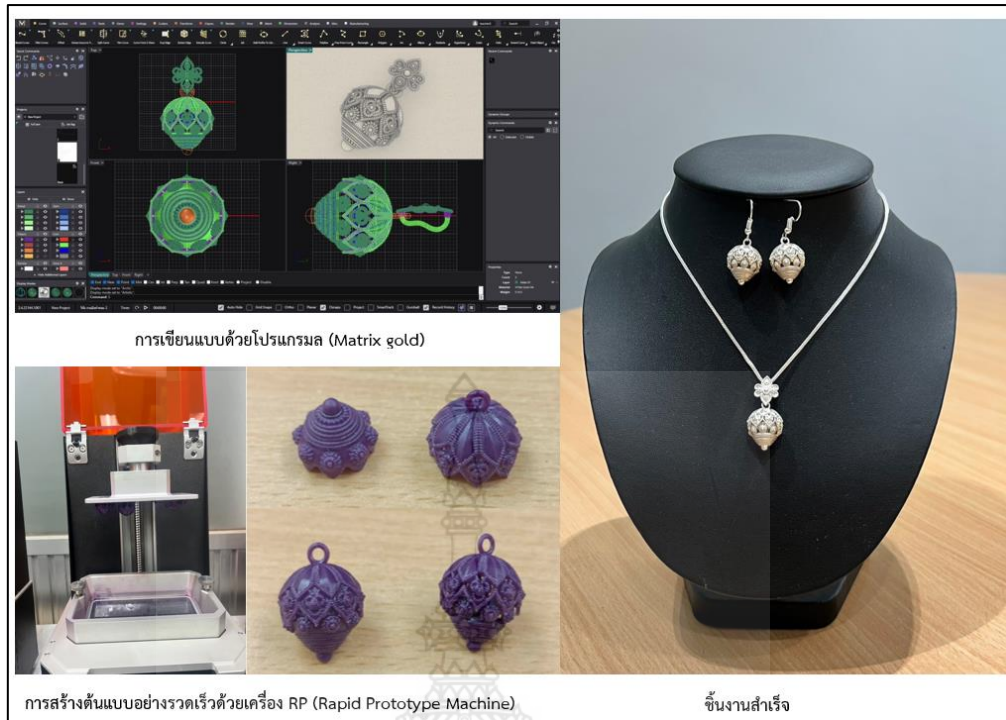
ภาพที่ 4.2 แสดงการผลิตด้วยเครื่องประดับ “กระดุม” ด้วยเทคโนโลยีสมัยใหม่
