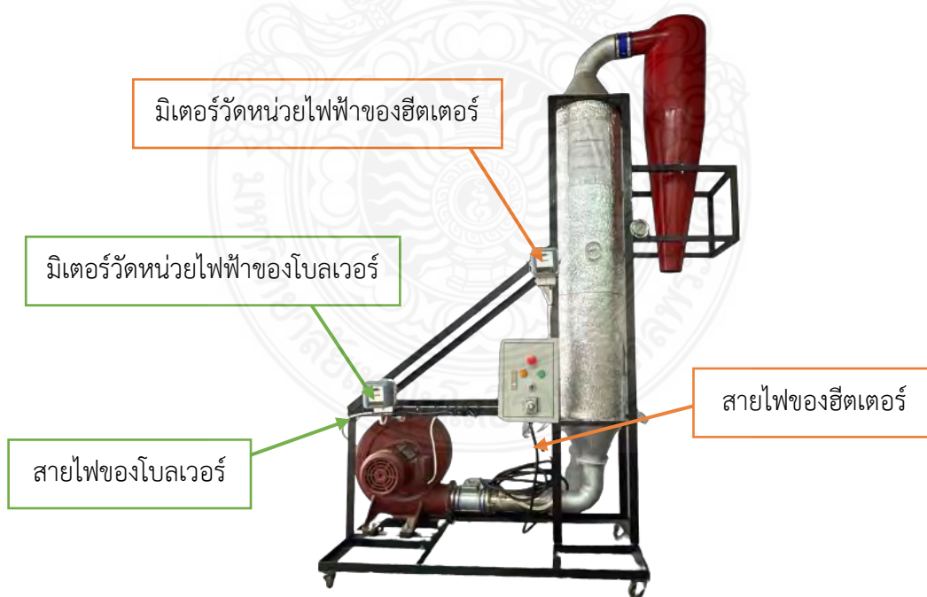
รูปที่ 3.7 เครื่องอบแห้งหลังการปรับปรุง
