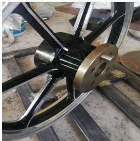
รูปที่ 3.5 การสวมพอดีปลอกรองแกนกับวงล้อที่ใช้กับเครื่องทดสอบ
