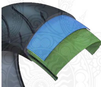
รูปที่ 2.6 โครงสร้างยางแบบเรเดียล
