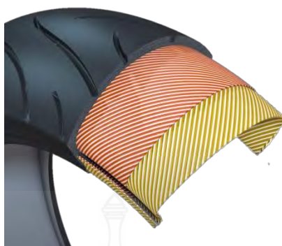
รูปที่ 2.5 โครงสร้างยางแบบไบแอส
