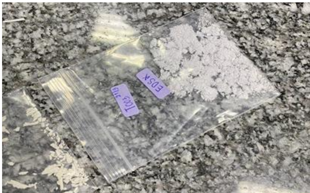
ภาพที่ 4.2 กระดาษที่ผ่านการปรับสภาพด้วยความร้อนและบดย่อยให้มีขนาดเล็ก
