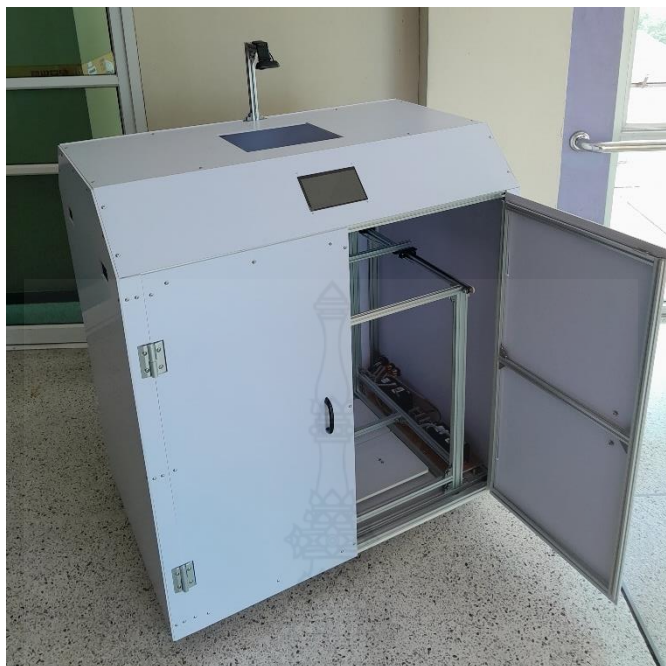
ภาพที่ 4.12 เครื่องต้นแบบการเปิดช่องบรรจุถังขยะด้านขวา
