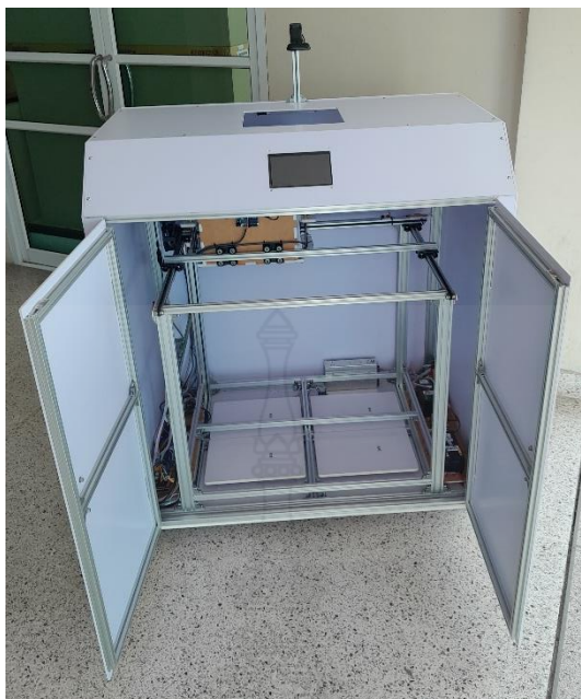
ภาพที่ 4.10 เครื่องต้นแบบการเปิดช่องบรรจุถังขยะมุมมองด้านหน้า
