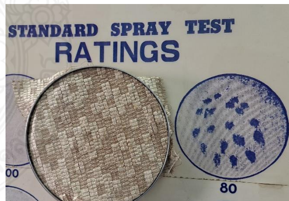
ภาพที่ 4.62 ผลการทดสอบการสะท้อนน้ำแบบ Spray Test
