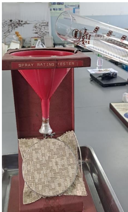
ภาพที่ 4.61 วิธีการทดสอบการสะท้อนน้ำแบบ Spray Test
