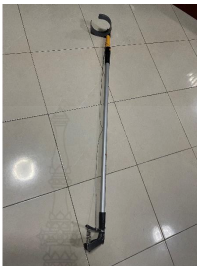
ภาพที่ 4.54 แสดงการปรับปรุงกลไกสปริงและการประกอบชุดก้านท่อ
