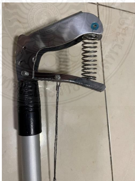
ภาพที่ 4.53 แสดงการปรับปรุงกลไกสปริงการห่อผลไม้แบบใช้มือบีบ
