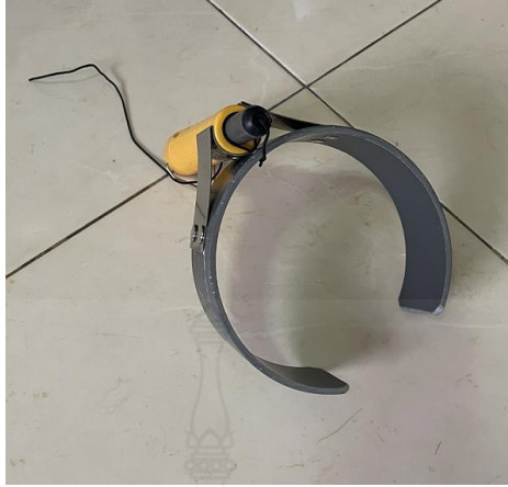
ภาพที่ 4.42 แสดงการประกอบอะไหล่ที่ใช้ในการห่อผลกระท้อน
