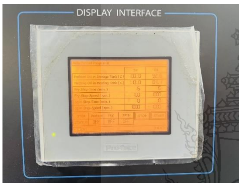
หอมแดงซอยทอดสภาวะที่ใช้อุณหภูมิในการทอดที่ 110^{\circ}\text{C} /15 นาที ภาพที่ ข.3 การทอดหอมแดงซอยด้วยระบบสุญญากาศ
