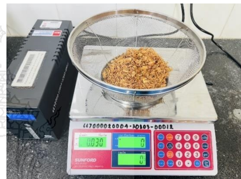
หอมแดงซอยทอดสภาวะที่ใช้อุณหภูมิในการทอดที่ 110^{\circ}\text{C} /15 นาที ภาพที่ ข.3 การทอดหอมแดงซอยด้วยระบบสุญญากาศ
