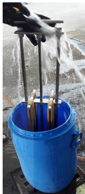
ภาพที่ 2.10 การบีบสารละลายโซดาไฟให้เข้าเส้นด้ายผสมอย่างทั่วถึง (ซ้าย) และการล้างสารละลายโซดาไฟด้วยน้ำสะอาดภายหลังการชุบน้ำ (ขวา)
