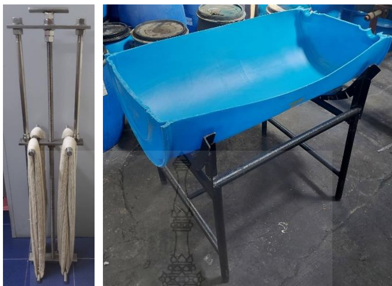
ภาพที่ 2.6 การซึ่งเส้นด้ายผสมกับอุปกรณ์จับยึด (ซ้าย) และภาชนะสำหรับใส่สารละลายโซดาไฟในการ ชุบมัน (ขวา)
