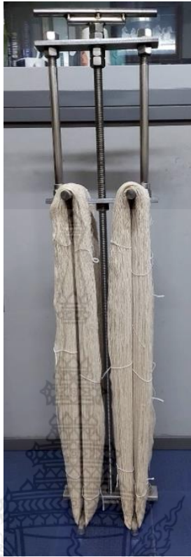
ภาพที่ 3.3 เส้นด้ายผสมระหว่างกัญชงและฝ้ายที่ถูกขึงตั้งเข้ากับชุดอุปกรณ์ชุบมันด้วยมือ
